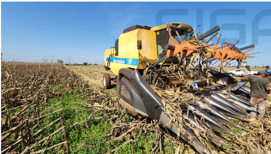
Foto do técnico Diego Batistela, adaptação para colheita de milho em área afetada por vendavais na região sul do estado, dia 28/06/2022.
